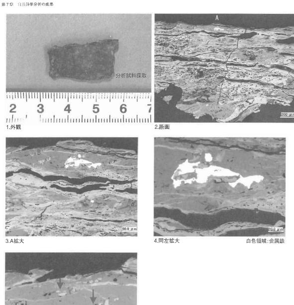
写真26 鉄片2の外観と断面組織
