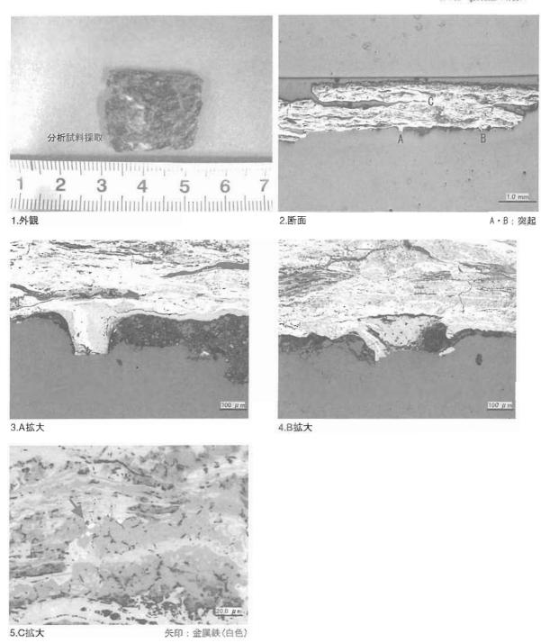
写真25 鉄片1の外観と断面組織
