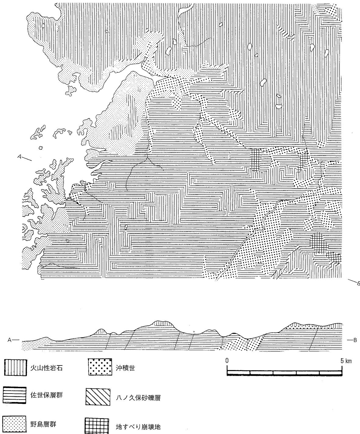
第1図 北松浦郡江迎町周辺の表層地質図及び地盤断面図 ( $S=1/100,000$ )
