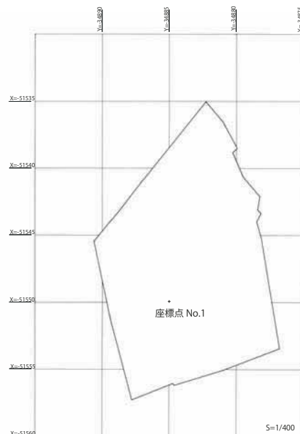
Fig.7 高田手永旧堤防座標点
