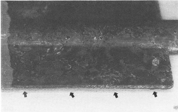
写真34 元部の鑄型のズレによる段差 (D71)
