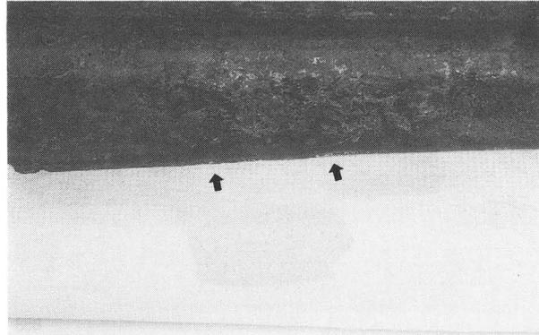
写真35 刃部の鑄型のズレによる段差 (C32)
