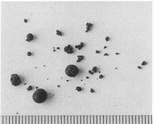
鍛冶炉痕跡周辺の土中から検出した鍛造剥片と粒状滓
