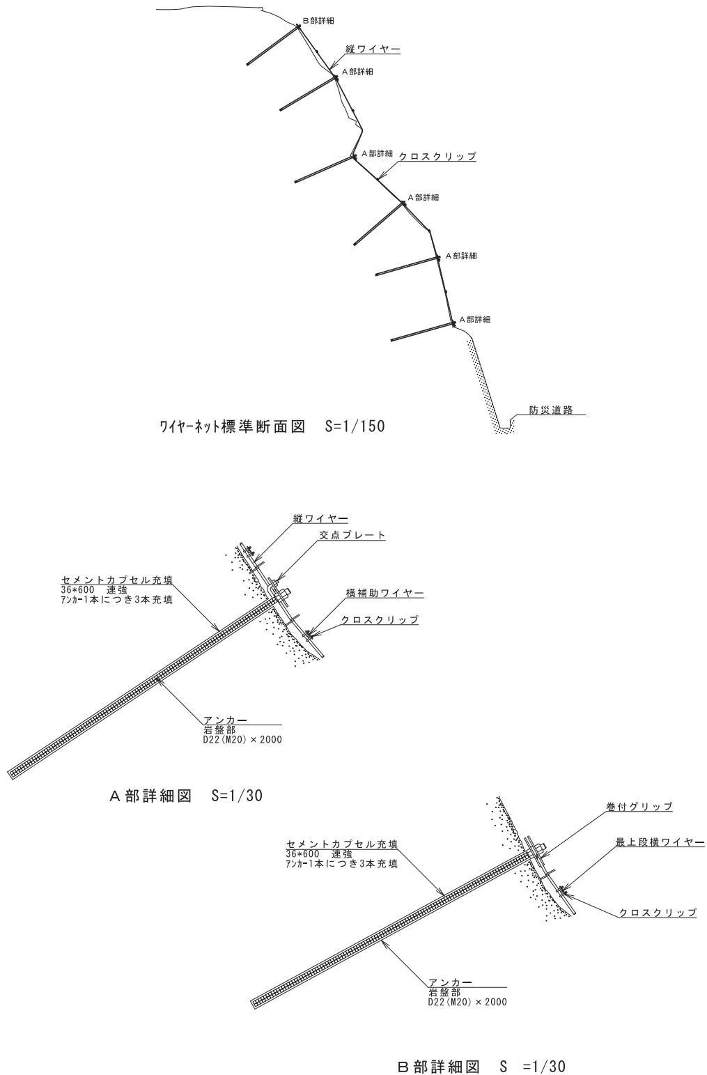
第17図 ワイヤーネット標準断面図及び各部詳細図
