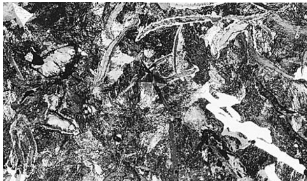
Photo.14 鍛造剥片・炉内滓・鉄塊系遺物の顕微鏡組織
