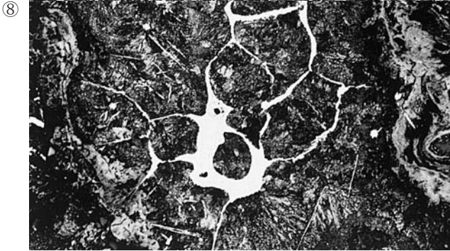
Photo.10 炉内滓 (含鉄) の顕微鏡組織
