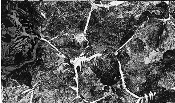
Photo. 9 炉内滓の顕微鏡組織
