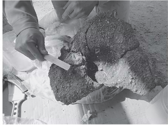
接合カ所の仕上げ (余剰接合剤の除去)
