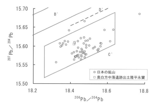
第84図 今回の隆平永寶と日本の鉱山の鉛同位体比 (<sup>206</sup>Pb/<sup>204</sup>Pb-<sup>207</sup>Pb/<sup>204</sup>Pb)
