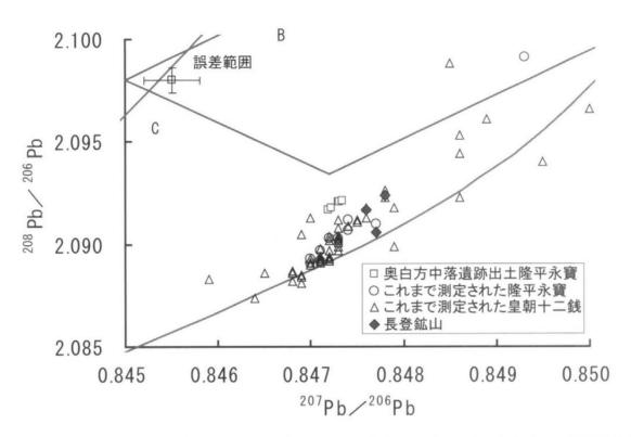
第85図 今回の隆平永寶とこれまで測定された隆平永寶・皇朝十二銭・長登鉱山の鉛同位体比 (<sup>207</sup>Pb/<sup>206</sup>Pb-<sup>208</sup>Pb/<sup>206</sup>Pb)
