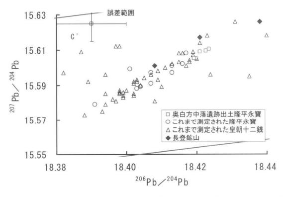
第86図 今回の隆平永寶とこれまで測定された隆平永寶・皇朝十二銭・長登鉱山の鉛同位体比  $(^{206}\text{Pb}/^{204}\text{Pb}-^{207}\text{Pb}/^{204}\text{Pb})$
