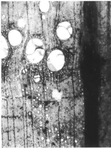
横断面 ————— : 0.5mm 放射断面 ————— : 0.2mm 接線断面 ————— : 0.2mm 1. 資料番号2 柱材 コナラ属コナラ節
