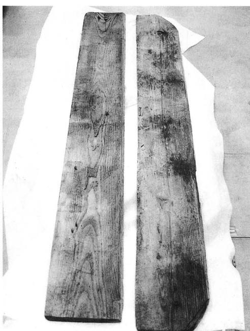
fig.259 PEG含浸完了後
