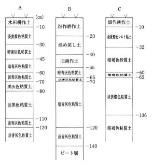
5 図 試掘坑土層柱状図
