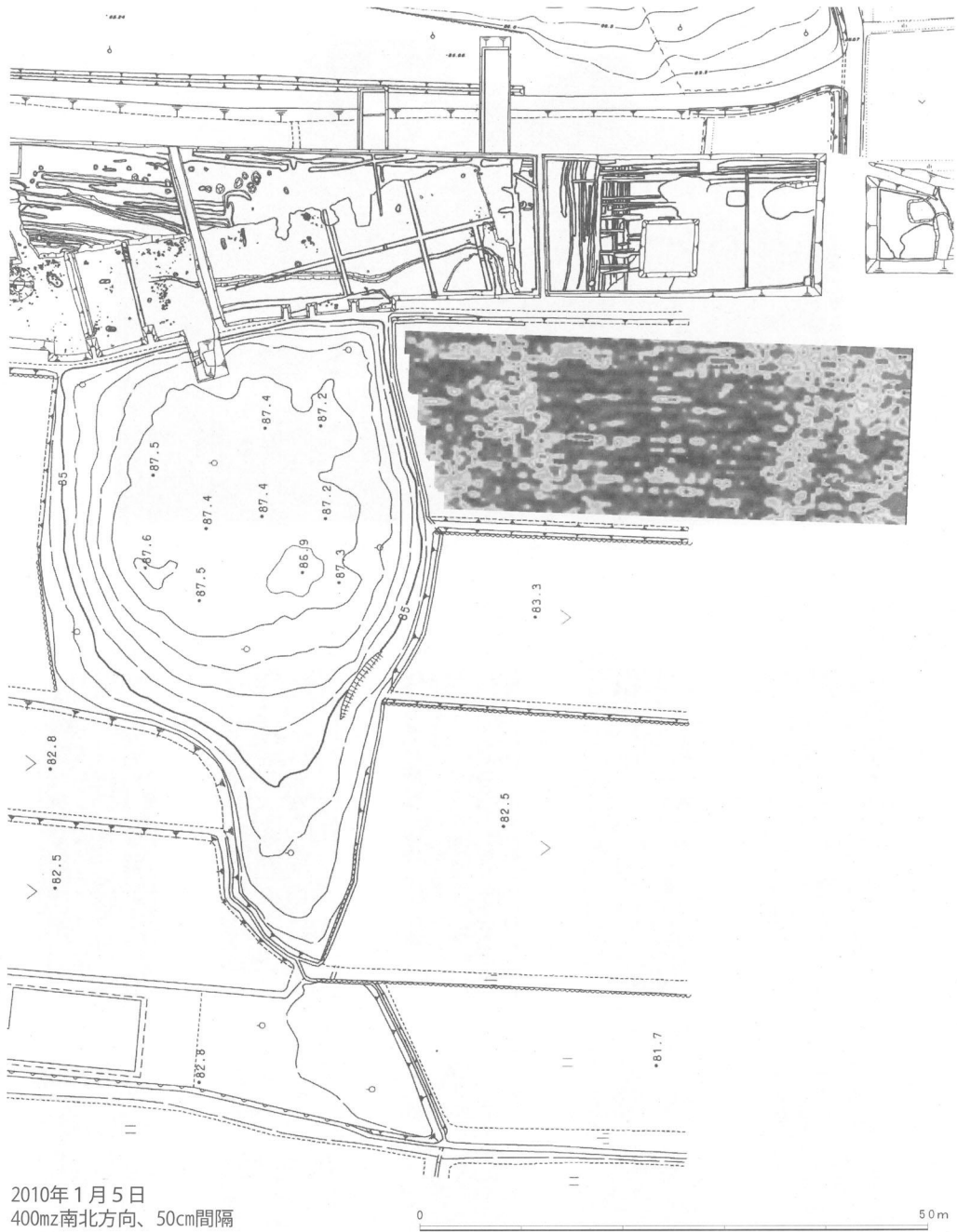
第15図 ノムギ古墳地中レーダ探査タイムスライス (36-41NS)
