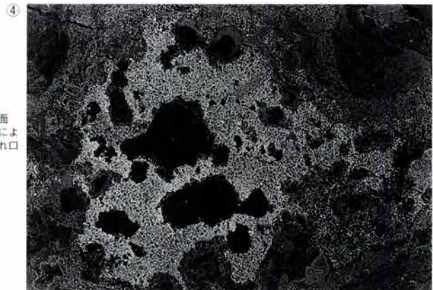
③：鑄造鉄片（板状、錆化）（STE-8）のマクロ組織（×10） ④：鉄塊系遺物（STE-10）のマクロ組織（×20）
