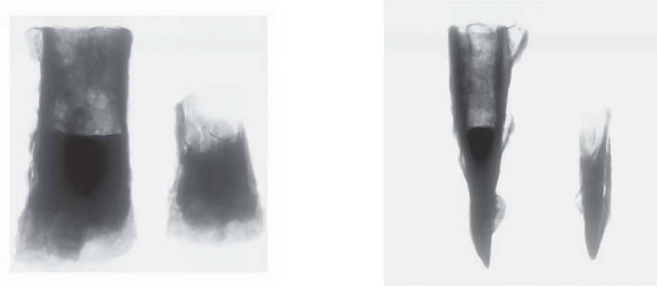
写真1 徳島県カネガ谷遺跡出土鍛造袋状鉄斧X線透過写真 (左：平面透過写真、右：縦断面透過写真)
