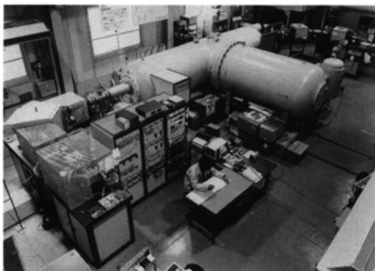
(写真1) 名古屋大学タンデロン加速器質量分析計の全体像
