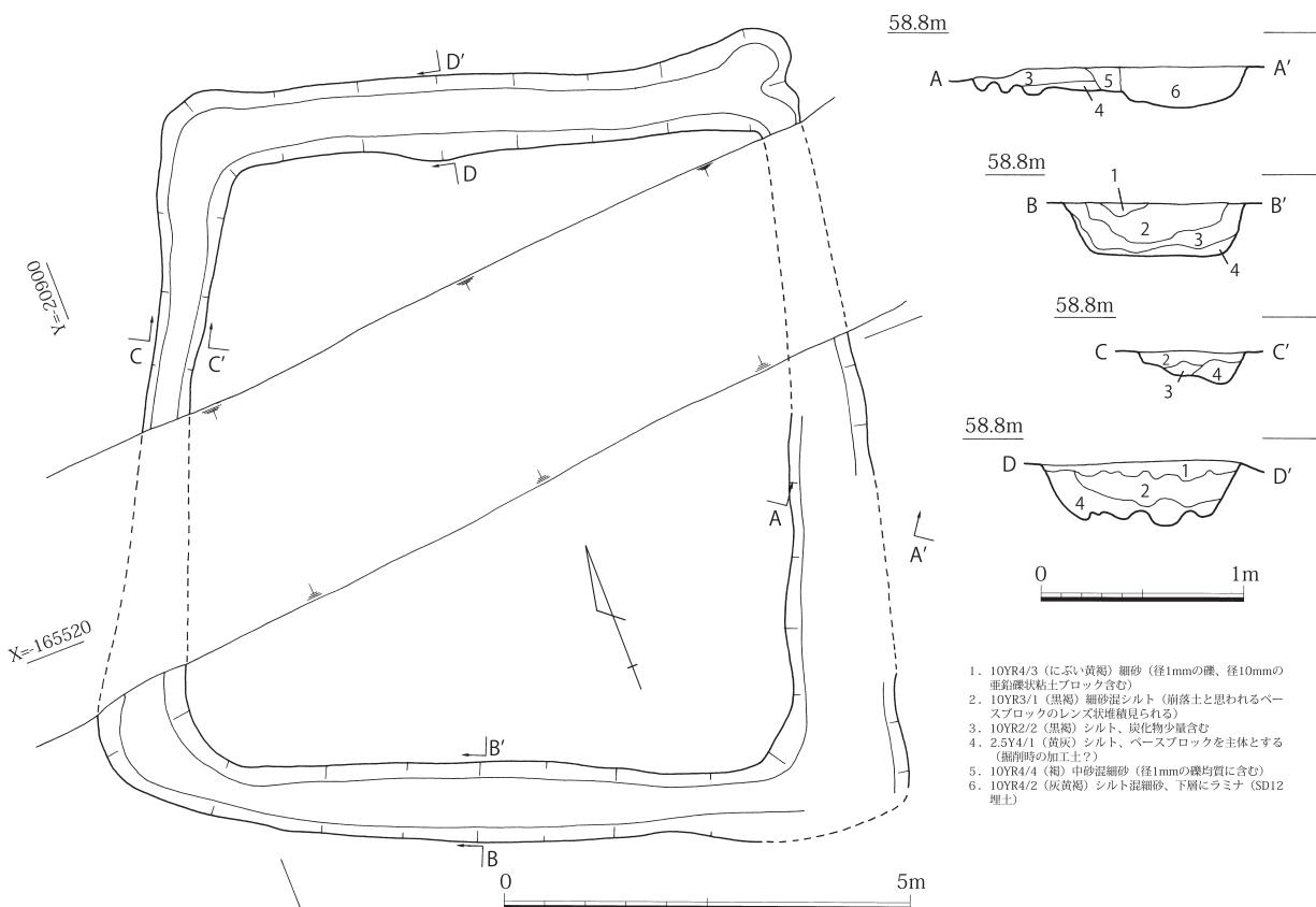
図7 SZ40 平面・土層断面図 (平面 S=1/100 土層断面 S=1/40)
