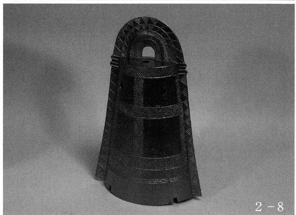
写真2 土製銅鐸鑄型による鑄造実験(2)
